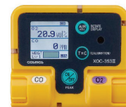
新コスモス電機 酸素・一酸化炭素計XOC-3531I
